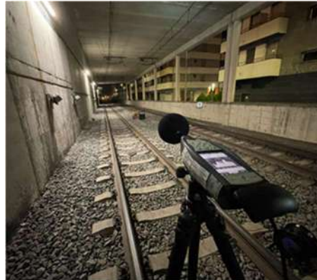
31. Irudia. Erreberberazioaren neurketak.
