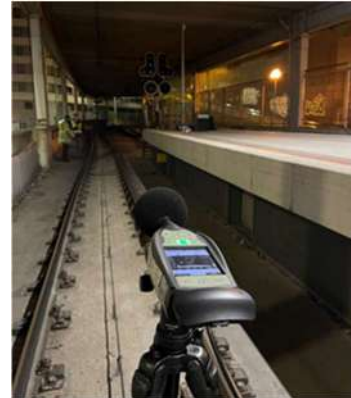
31. Irudia. Erreberberazioaren neurketak.
