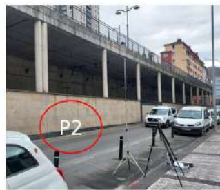
99. Irudia. P1, P2 eta P3 puntuak – Neurketak trenak igarotzean.
