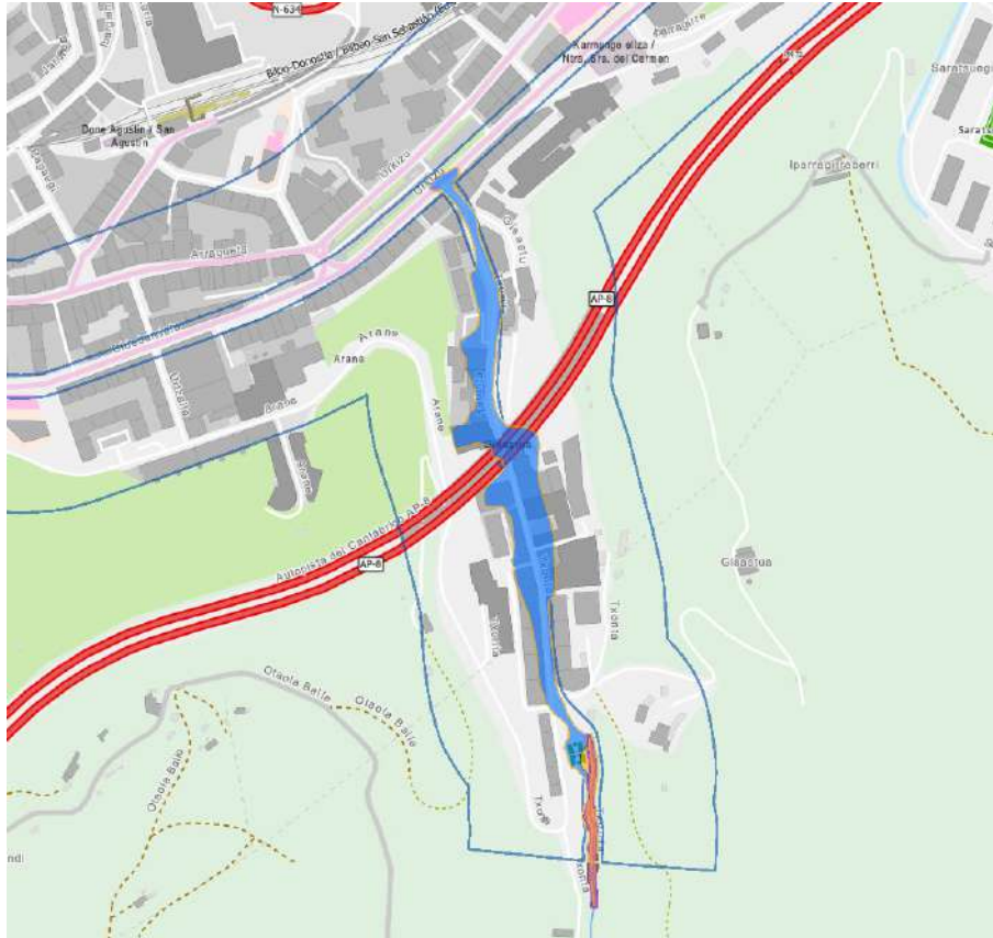
Imagen del visor de URA en Geoeuskadi (en azul "Inundabilidad de 500 años de periodo de retorno", en naranja "Inundabilidad de 100 años de periodo de retorno" y en rojo naranja "Inundabilidad de 10 años de periodo de retorno")
